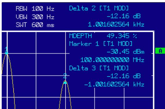
Fig. 5-10 Mesure du taux de modulation AM. Le taux de modulation affiché est MDEPTH = 49,345 %. La fréquence du signal AF est indiquée dans la zone d'affichage de la fréquence des marqueurs delta.
